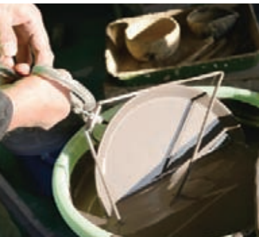
上／分業を担う型屋では、各窯元から受注した量産用の型を作成している。右下／陶石を粉末、液状にしたものを、器の型に流し込む作業。左下／彩色の後、器の表面がなめらかになるよう釉薬に浸す。
