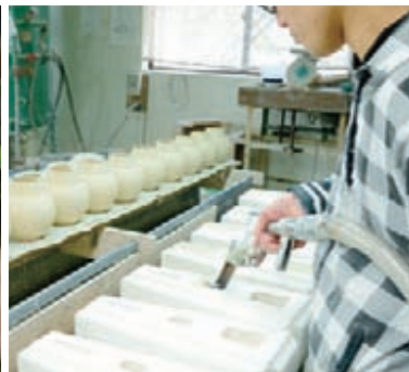
上／分業を担う型屋では、各窯元から受注した量産用の型を作成している。右下／陶石を粉末、液状にしたものを、器の型に流し込む作業。左下／彩色の後、器の表面がなめらかになるよう釉薬に浸す。
