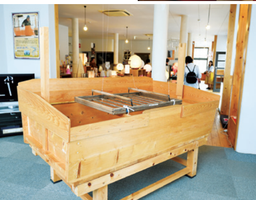
右／アート展での受賞作品などを展示する「美濃和紙あかりアート館」の作品。下／紙すき用の舟。コウゾと水、トロロアオイを入れ、竹箒で舟の中の液をすくって揺すり、一枚ずつ紙をすいていく。
