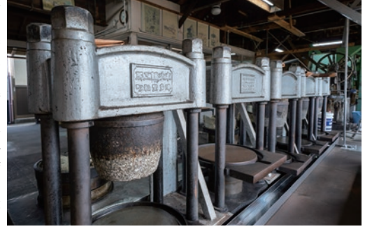
高田製油所の椿油は、粉碎して蒸した椿の実を、油圧ポンプを使った圧搾機でゆっくり圧力を加えて圧搾する。作業中、製油所内は圧搾された椿油の甘い香りに満たされる。
