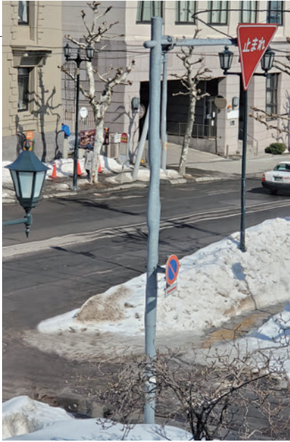
明治時代に造られた平面ガラス越しに見た外の風景。円筒形に吹き膨らましたガラスを切り開き、板状にして造っていたため表面が滑らかではなく、道路標識の支柱（写真中央）が波打って見える。
