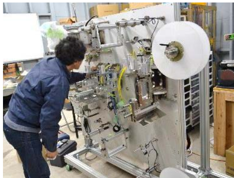
補助金を活用して開発した「救急絆創膏の ハイドロジェル材巻きシートのカット加工装置」
